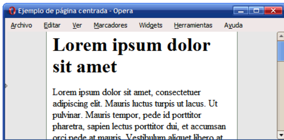
Figura 12.2. Página de anchura fija centrada mediante CSS
