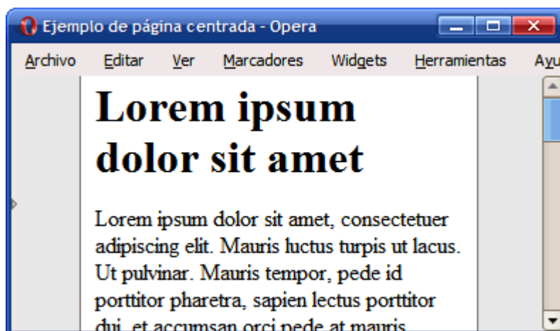
Figura 12.4. Página de anchura variable centrada mediante CSS
